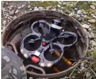
マンホールから進入する ELIOS 3
